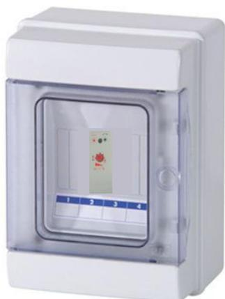
**Interruttore crepuscolare** di grande potenza. MEGA ONE permette di gestire le accensioni Day-Night da 3000 e 5000 Watt. Resistenza agli urti: IK08. Colore grigio RAL 7035 e portello trasparente. Grado di protezione IP 65 stagno. Contenitore realizzato secondo le norme CEI 23-48, CEI 23-49, IEC60670-1.
