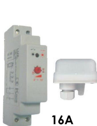
**Interruttore crepuscolare** in contenitore guida DIN ad 1 posto, montaggio su barra 35 mm (En500022). Elemento fotosensibile esterno (IP55). Possibilità di regolare la sensibilità di intervento da 1 a 500 lux. Alimentazione 230 Vca - 50 Hz.
