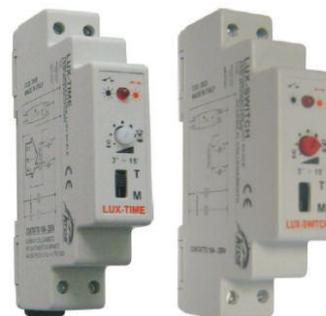
**Temporizzatore per luci scale** in contenitore DIN ad 1 posto. Possibilità di regolare una scala tempi da 3 sec. a 15 min. Collegamento 4 o 3 fili REX elettromeccanico + neutro. Utilizzabile con impianti dove sono presenti pulsanti luminosi. **Interruttore per l'accensione fissa della luce.**
