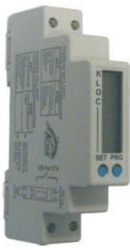
**Interruttore orario digitale** con contatto alimentato, in grado di programmare e comandare sia l'accensione che lo spegnimento di un carico elettrico. La programmazione di estrema facilità è assicurata da 2 tasti sul frontale e dalla presenza del display digitale. Il timer può ricevere da 1 a 10 programmazioni giornaliere. 1 modulo DIN. La versione a 10 accensioni è disponibile anche con programmazione ciclica (KLOC C). Versioni disponibili 230V, 12V, 48V e 110V.
